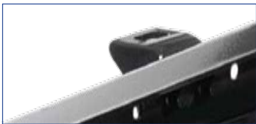
底盤大樑上的托架有利於車體的打造固定
