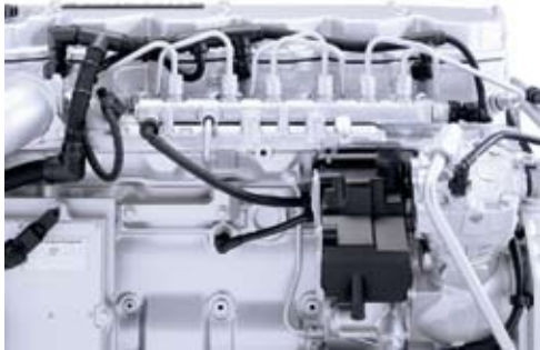
搭配了高壓共軌噴油設備可使引擎更有力，更省油
