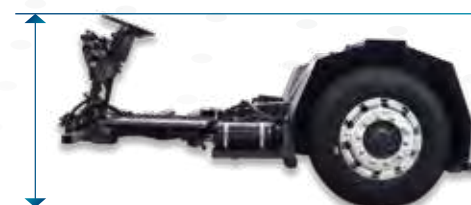
方向盤距地高度降至 1450mm 符合台灣市場需求
