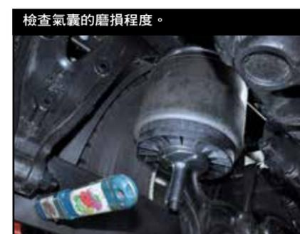
檢查氣囊的磨損程度。
