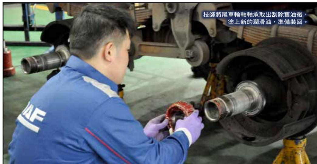
技師將尾車輪軸承取出刮除舊油後，塗上新的潤滑油，準備裝回。
