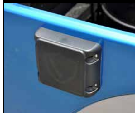
助手側盲點警示系統的雷達感知器，安裝在側裙上。
