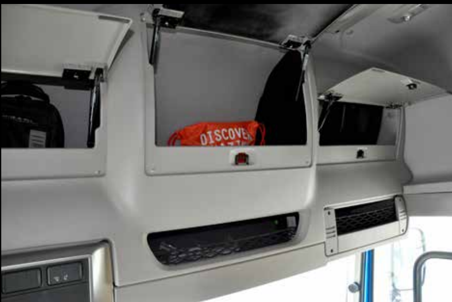
頭頂上方增加三個超大型的置物箱，蓋子都是油壓可掀式，操作上很輕鬆。
